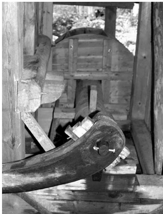
Närmast vevan som sitter på hjulköbben, som går ut till vattenhjulet.
