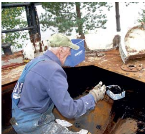
Gunnar arbetade med målning efter att hela aktern fått nya plåtar på bogserbåten Borgvik.
