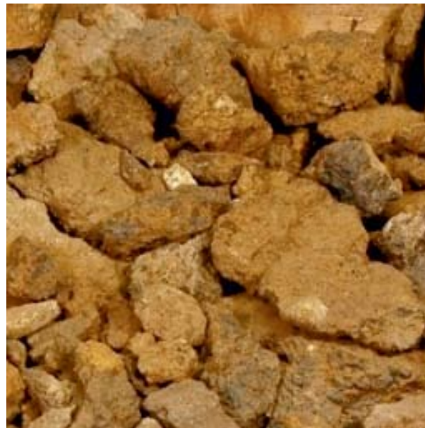
Sjömalm, järnoxidhydroxid ( \text{FeO(OH)} )
